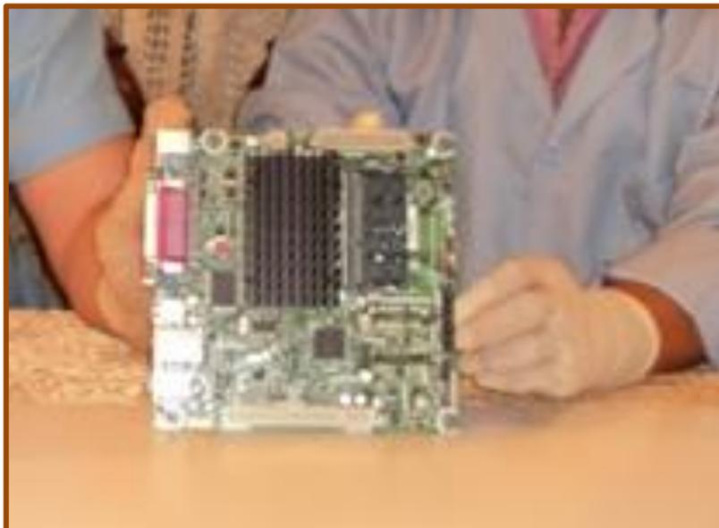
**PASO 3: Colocación de board,** sujetar la tarjeta madre y atornillar en los 4 puntos base hasta que quede fija (proceso similar en case).
