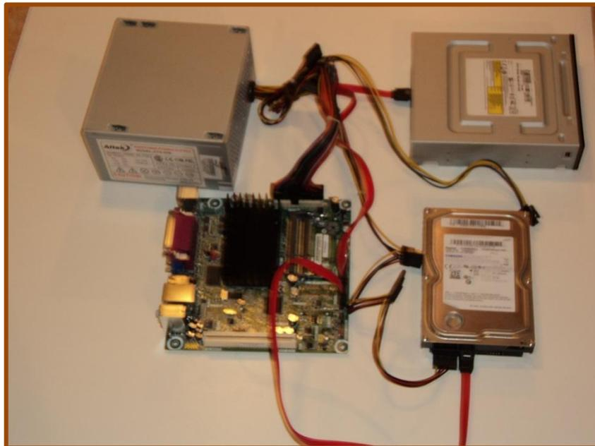
**PASO 15:** *Conexión de Fuente de Poder conector 2x2 con chaflán*, acoplar conector 2x2 con chaflán de tarjeta madre para alimentación de energía.
