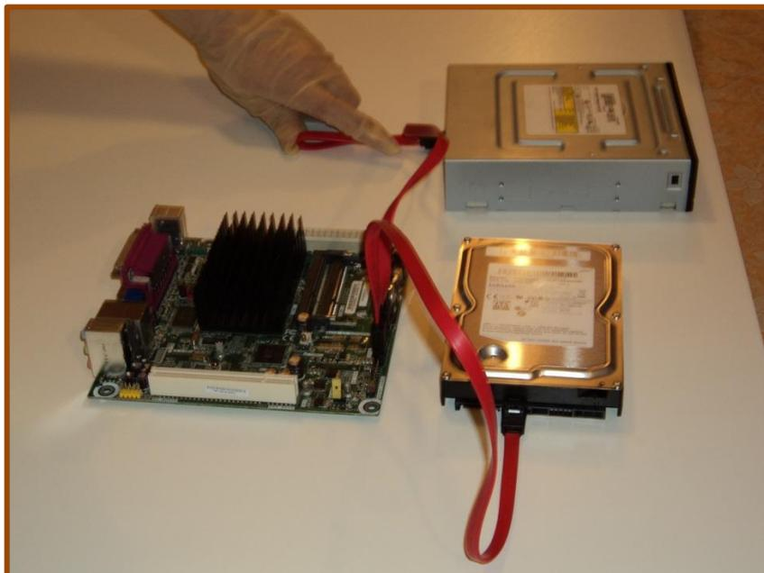
**PASO 9: Conexión de Fuente de Poder con board, conector 20+4 pines en board.**
