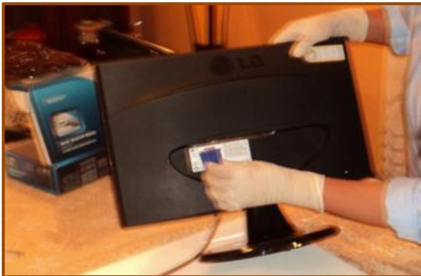
**PASO 23: Conexión monitor con board,** mediante cable de video tipo serial VGA introducir en la parte posterior de la board toma color azul y asegurar con tornillos del plug.
