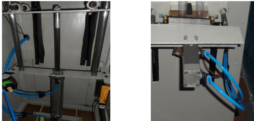
Gráfico N° 3.13 Funcionamiento de un Cilindro neumático de doble efecto.
