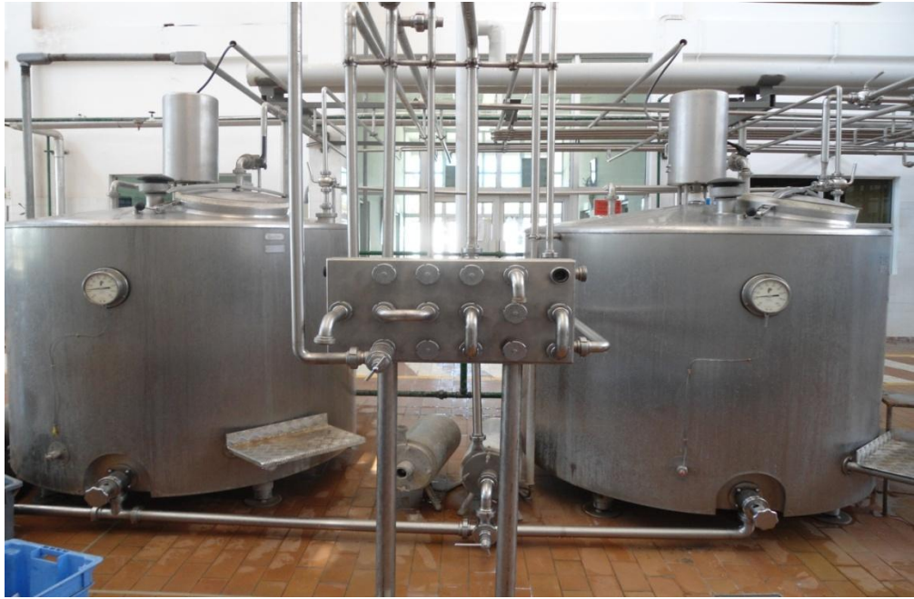
FOTO Nº- 5 Pasteurizador de Leche
