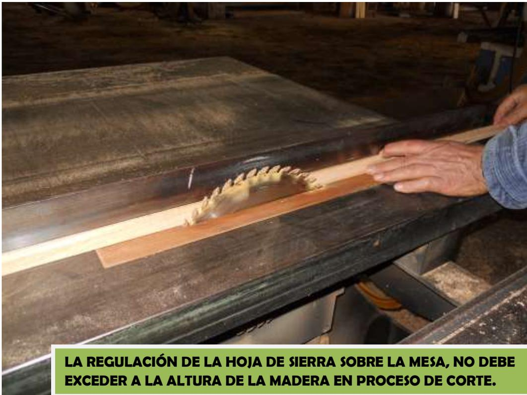
**LA REGULACIÓN DE LA HOJA DE SIERRA SOBRE LA MESA, NO DEBE EXCEDER A LA ALTURA DE LA MADERA EN PROCESO DE CORTE.**
