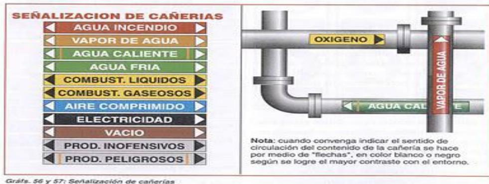
Figura: 2.1. Identificación de colores y su descripción en las tuberías. Fuente: (<http://www.amawebs.com/storage/docs/h33bd36edue.pdf>)
