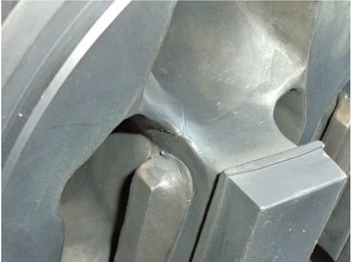
Figura. 3.28 Rotura de Matriz por exceso de Mg
