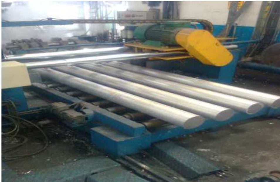
Figura 3.15 Lingotes sobre la mesa expulsora.
