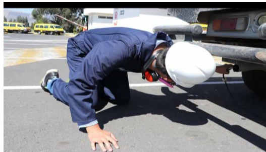
Fotografía N° 5 Introducción de la sonda al tubo de escape
