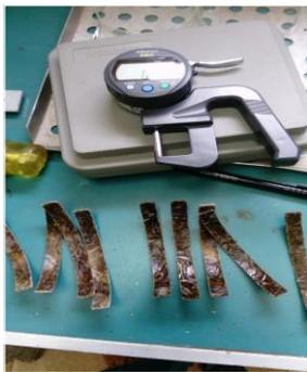
Medidor de espesor
