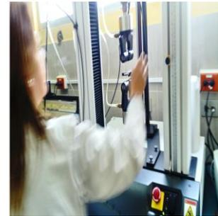
Colocación de la muestra en el equipo de ensayo
