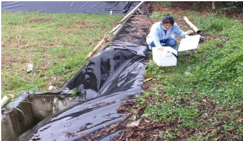
Toma de muestras a la salida de la planta de tratamiento de aguas residuales
