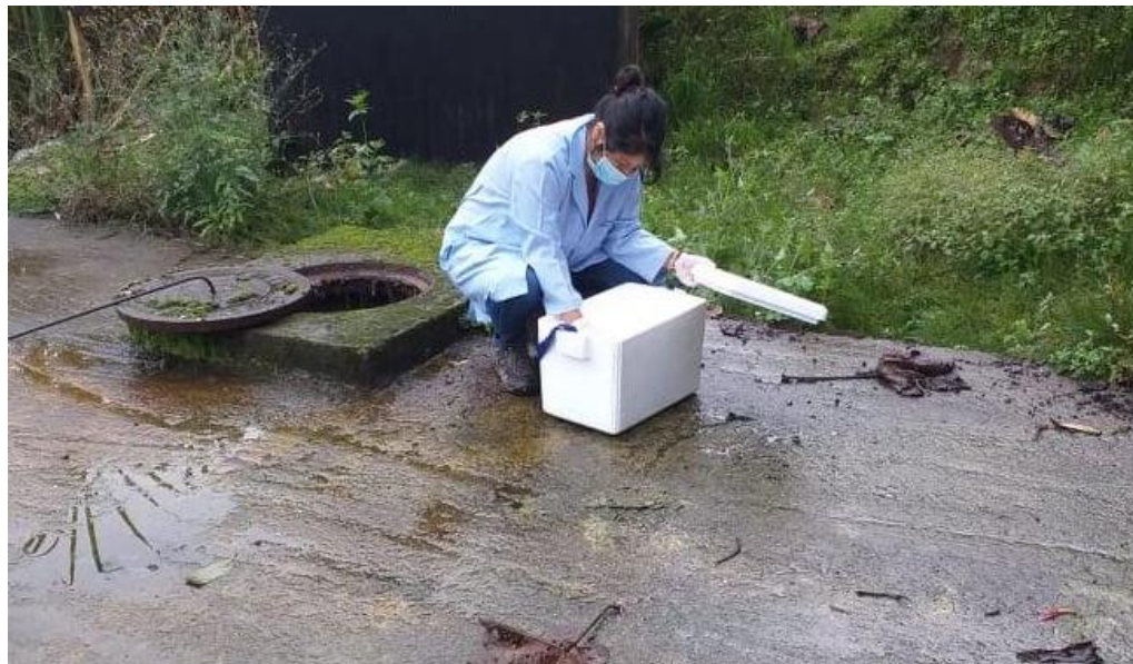
Toma de muestras a la entrada de la planta de tratamiento San José
