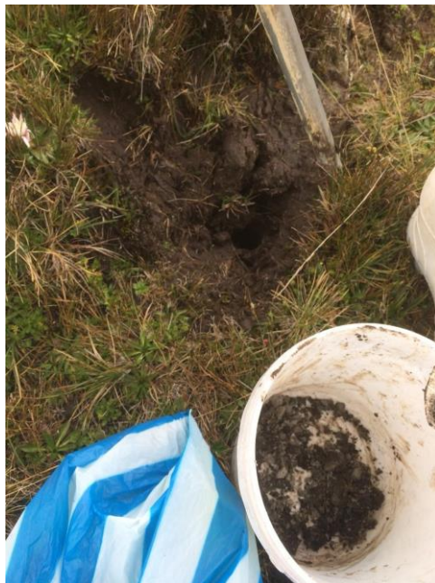
Figura 38: Extracción de la muestra
