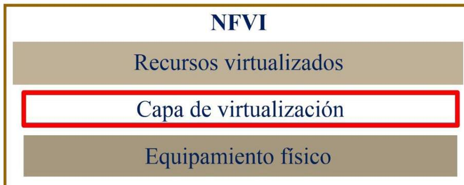
**Figura 13.** Componentes de la infraestructura de la NFV
