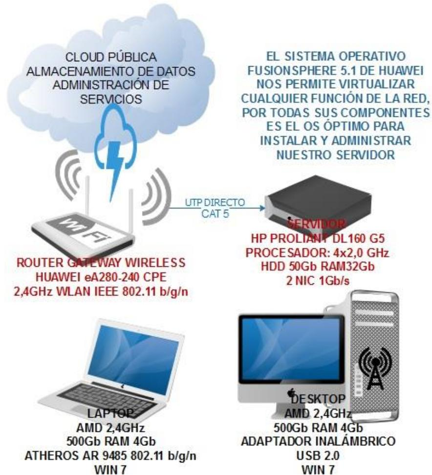
**Figura 14.** Diagrama de infraestructura de red NFV proyectada
