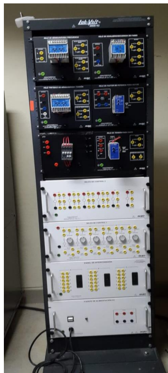
Figura 1. Modelo 3806-42 Puesto de control de relés de protección Fuente: [1]
