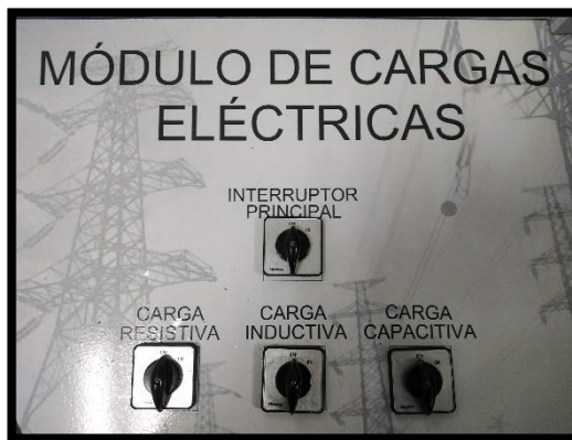
Figura 2.16. Módulo de Cargas Eléctricas Internas.
