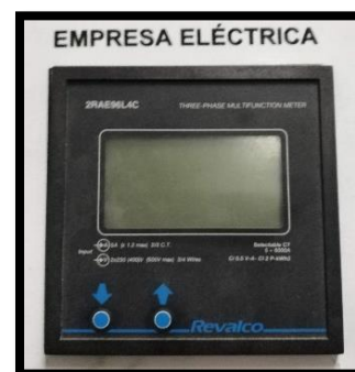
Figura 2.6. Multímetro Digital de la Empresa Eléctrica.
