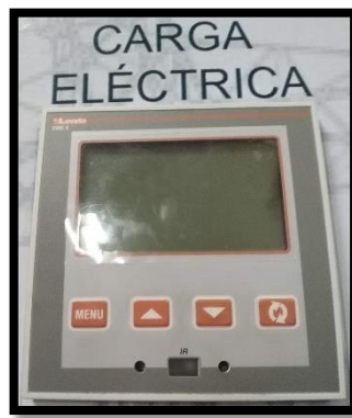
Figura 2.13. Multímetro de la Carga Eléctrica.
