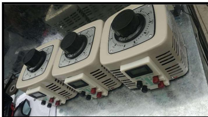
**Figura 4.** Banco de Autotransformadores.
