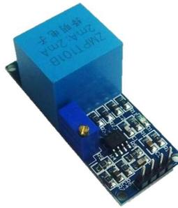
**Figura 3.35.** Sensor de Voltaje.
