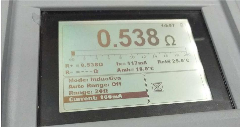
Figura V.2. Prueba en el microhmetro en el primario del transformador con una corriente de 100mA.
