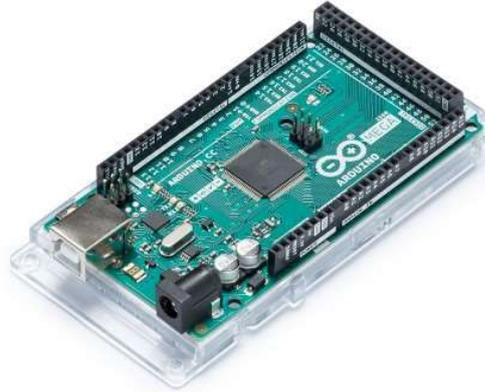
**Figura 3.32.** Arduino Mega.
