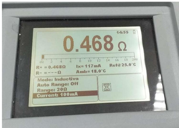
Figura V.4. Prueba en el microhmetro en el secundario del transformador con una corriente de 100mA.
