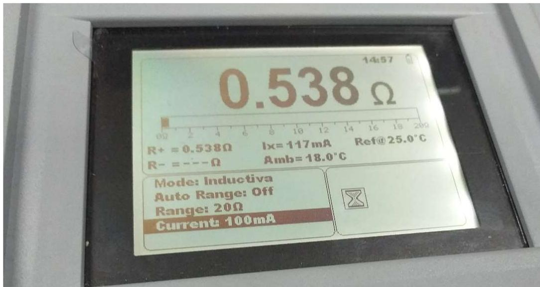
Figura 5.5. Prueba en el microhmetro en el primario del transformador con una corriente de 100mA.
