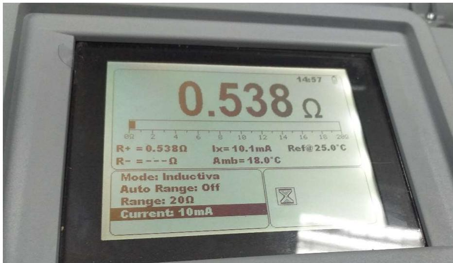
**Figura V. 1.** Prueba en el microhmetro en el primario del transformador con una corriente de 10mA.
