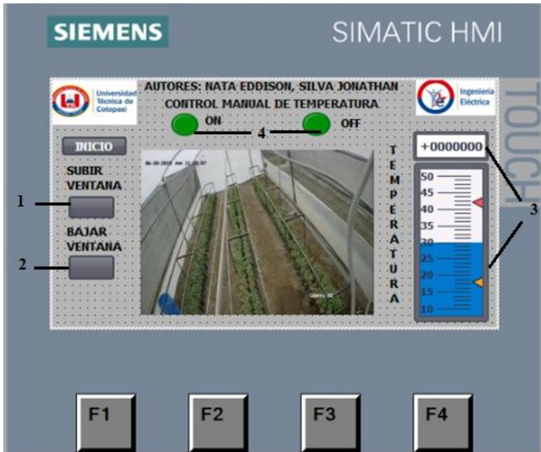
**Imagen 8 Pantalla de control manual de temperatura, detalles.**
