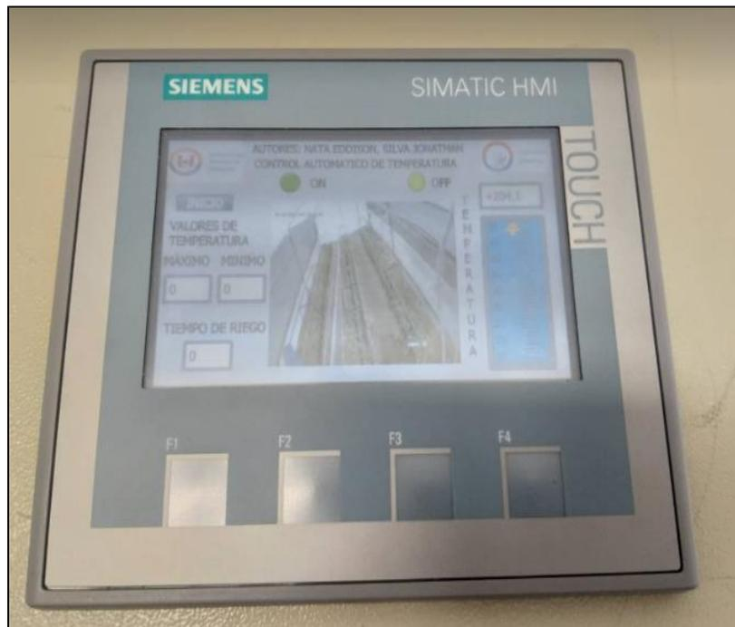
**Fig. III. 4.** Sistema de control de temperatura para el usuario
