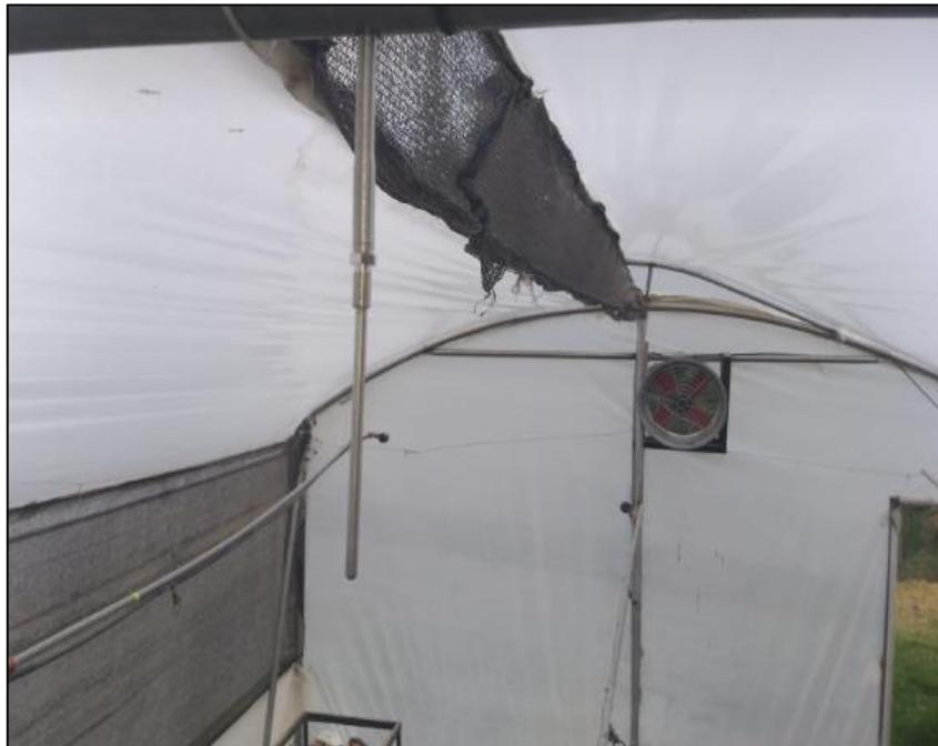
**Figura I.10.** Implementación del termocupla tipo k con extractor en funcionamiento
