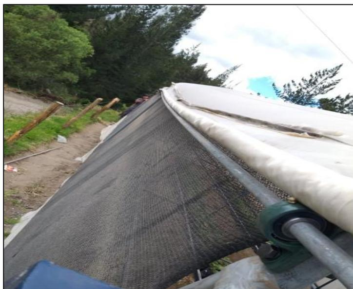
**Figura 5. 19** Vista lateral de las chumaceras acopladas con el tubo metálico
