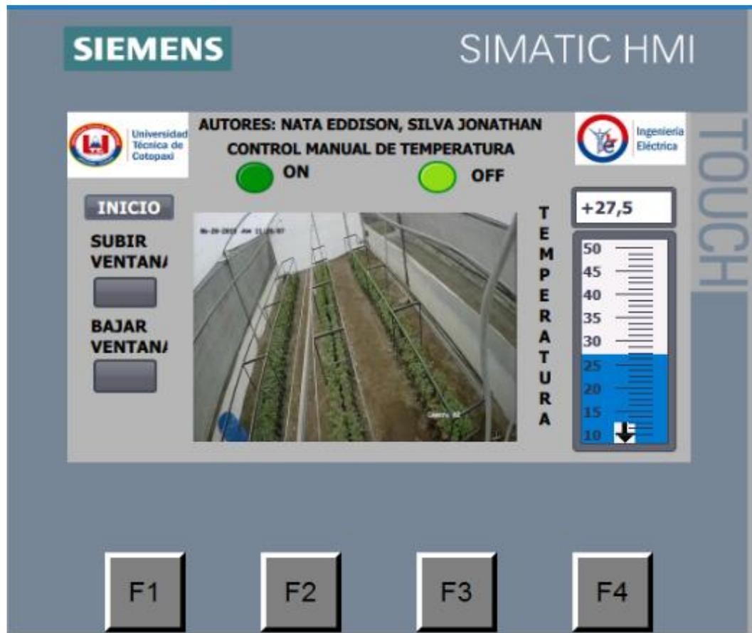
Imagen 9 Pantalla de control manual de temperatura, funcional.
