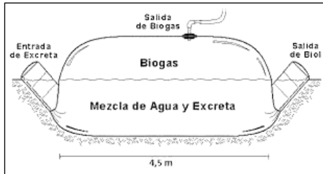
Figura 3.7. Esquema de un biodigestor de estructura flexible (tubular). Fuente: [32].
