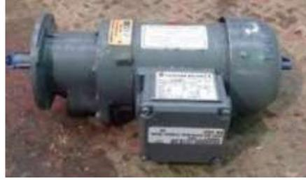
Velocidad de salida: (RPM) 44
