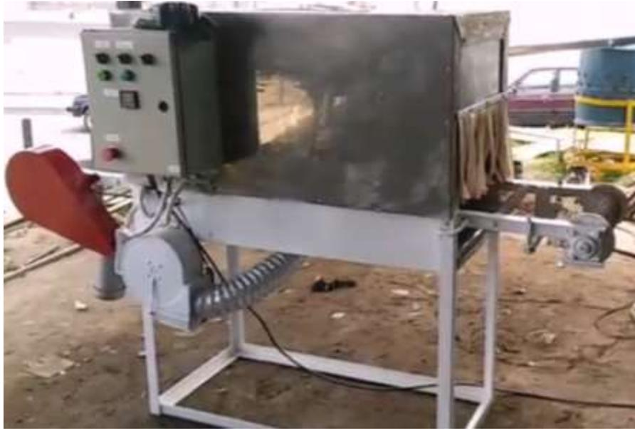
**Figura 5.5.** Empaquetadora por termo encogido
