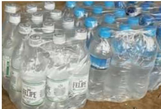
**Figura 5.4** Producto empaquetado mediante el termo encogido
