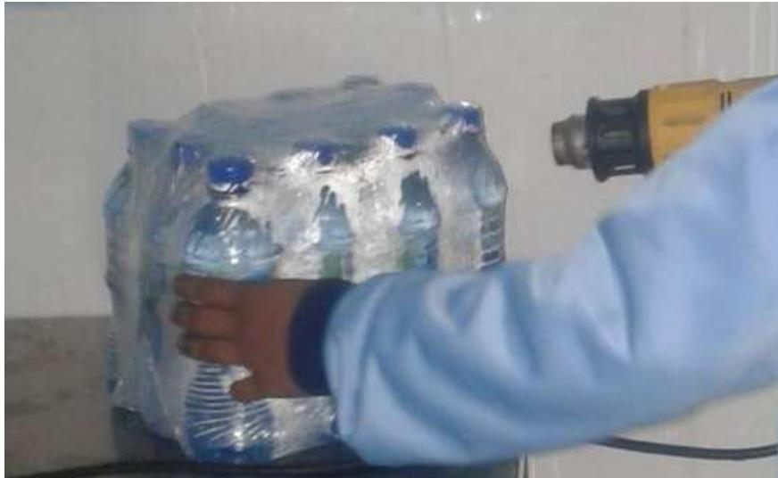
**Figura 5.1.** Paquete de botellas mediante el uso de la pistola de calor
