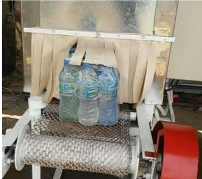
**Figura 5.3** Recorrido del paquete de botellas por el túnel de calor
