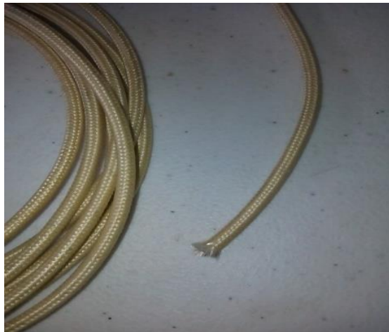
Figura 4.8. Cable de alta temperatura usado en la Instalación del horno ahumador
