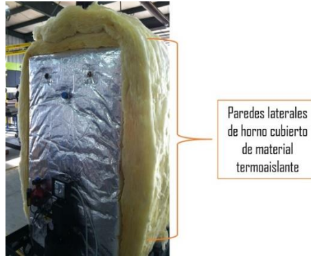
Figura 3.18. Horno eléctrico recubierto de material termoaislante
