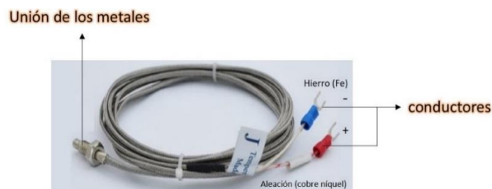
Figura 4.1. Termocupla tipo J implementada en el ahumador
