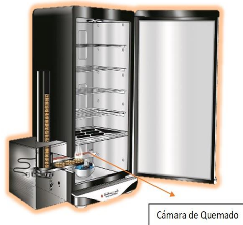
Figura 3.14. Cámara de quemado ubicada en la parte interior del horno ahumador
