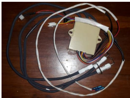
Figura 4.4. Encendedor eléctrico utilizado en el sistema de encendido del ahumador
