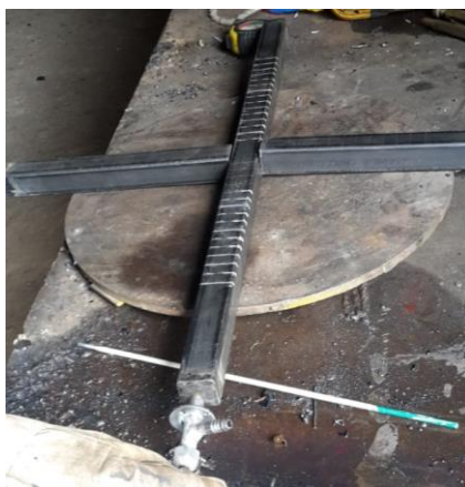
Figura 4.10. Flautín de gas utilizado en el horno ahumador
