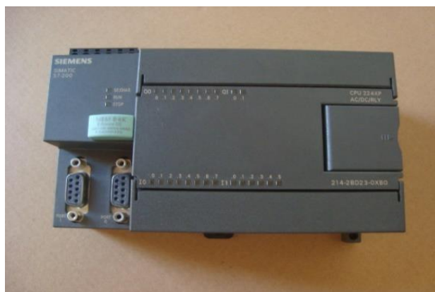
Figura 4.6. PLCS 7200 utilizado en la Programación
