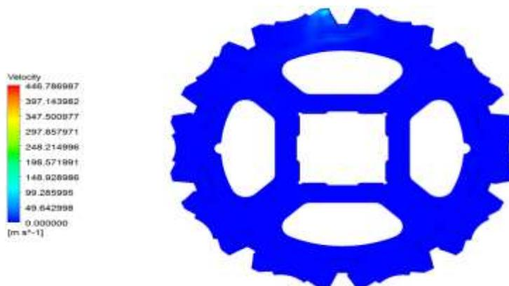
**Figura V.34.** Velocidad de inyección
