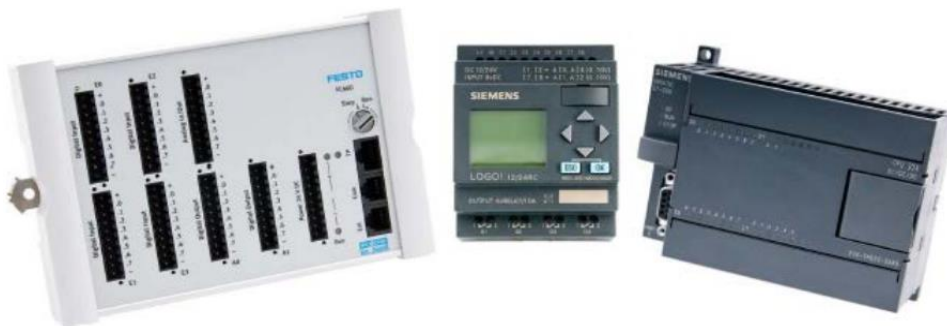
Figura 3.16: PLC Festo FEC FC660 PLC (a la izquierda), Siemens Logo RC230 (en el medio) y S7-200 PLC (a la derecha).
