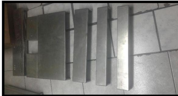
**Ilustración 7.** Trazado y perforado de la lamina de tool 1.1mm
