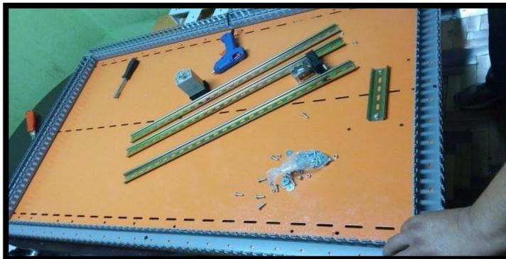
**Ilustración 11.** Colocación del riel DIN
