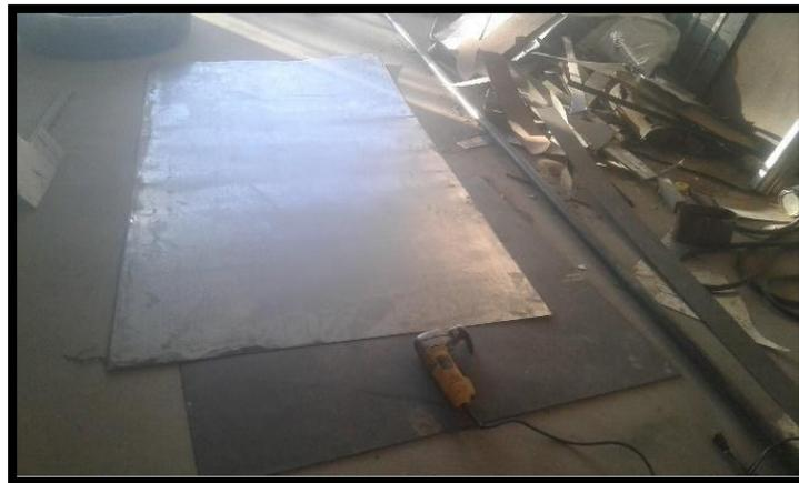
**Ilustración 5.** Cortado y doblado de la lamina de tool 1.1mm
