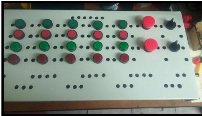
**Ilustración 10.** Inicio de armado del tablero de control
