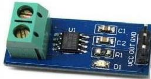
Figura 10: Sensor de corriente allegro ACS712TELC 30A \pm 30A
