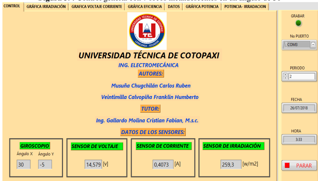
Figura 39: Control general con 7 focos incandescentes en un ángulo de 30^\circ
