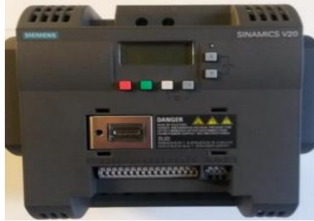
Figura 4. 6. Variador de frecuencia.
