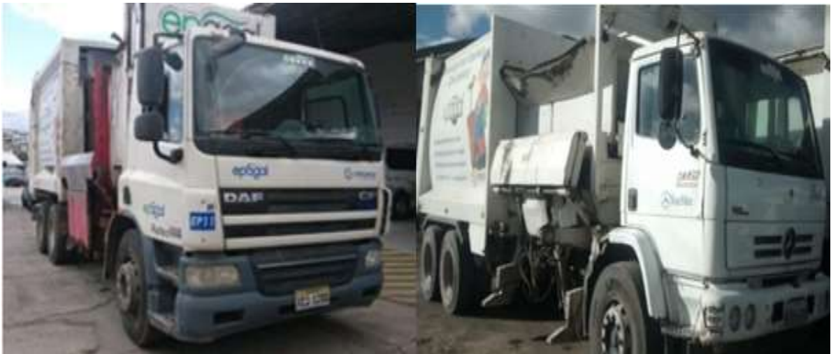
Figura 14: Vehículo recolector de desechos sólidos con sistema de funcionamiento de carga lateral, sistema THEMAC Y MAXXUM.
