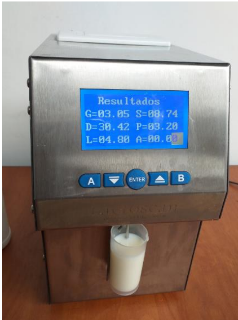
Fotografía 7. Analizador de leche LACTOSCAN utilizado en la empresa de Lácteos FINO.
