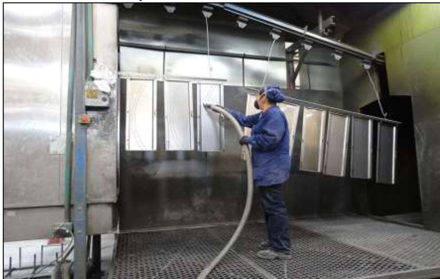
Ilustración 5: Secado de piezas metálicas
