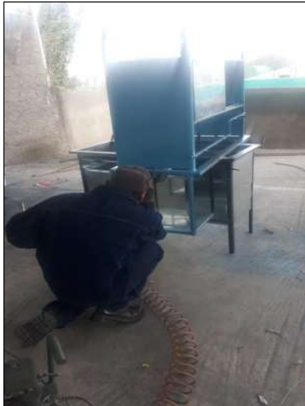
Recubrimiento total de pintura liquida
