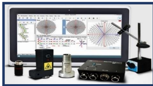
Figura 3.12 Elementos del sistema de adquisición de datos Erbesd DigivibeMX 10.
