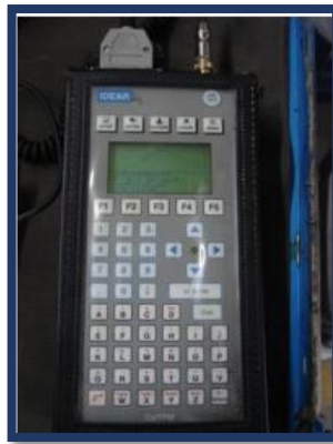
Figura 5.21 Equipo portátil de Análisis Vibracional VibraCHECK AB 3200
