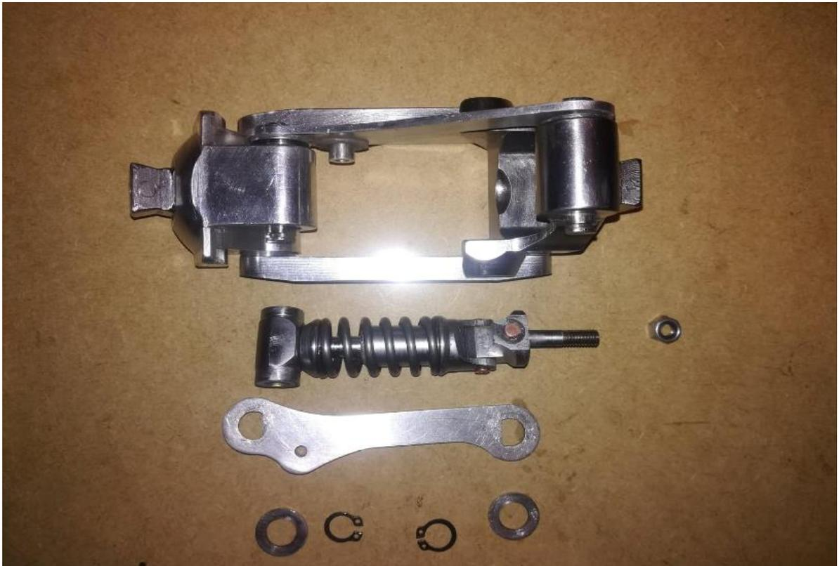
**Figura VII-16** Unión de amortiguador a sistema de movilidad.
