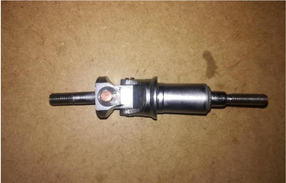
**Figura VII-13** Cilindro con base inferior.
