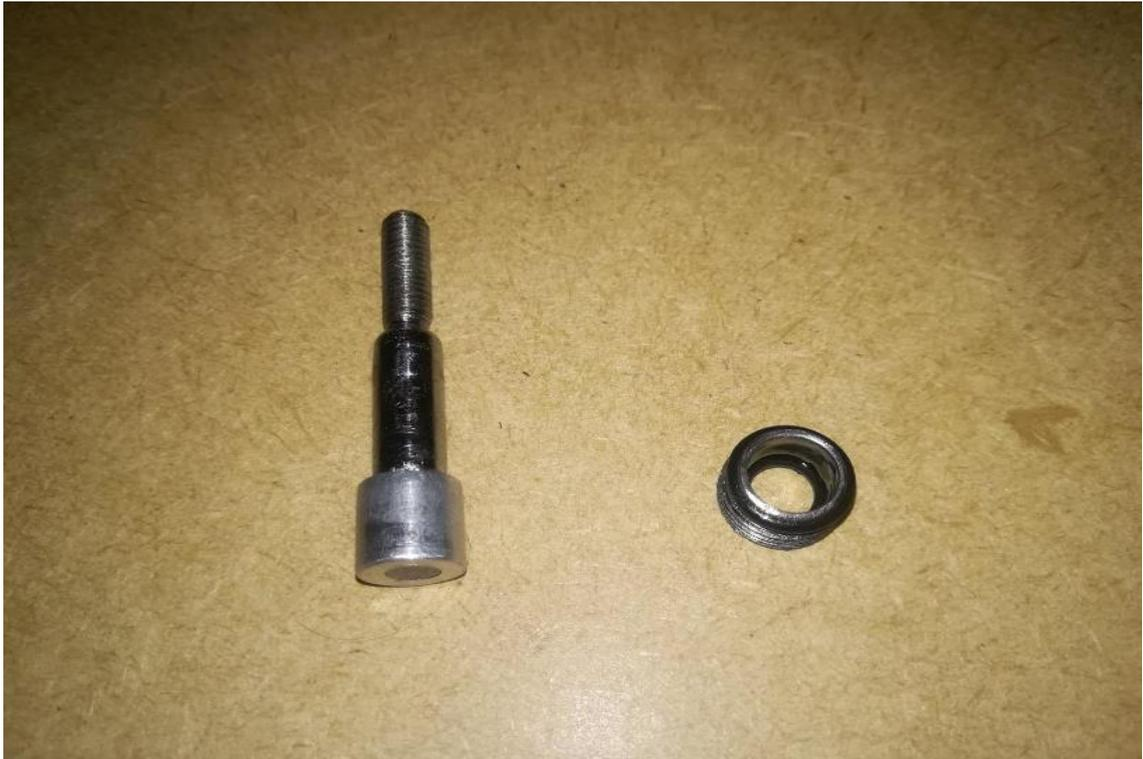
**Figura VII-9** Unión de émbolo y tapa cilindro.
