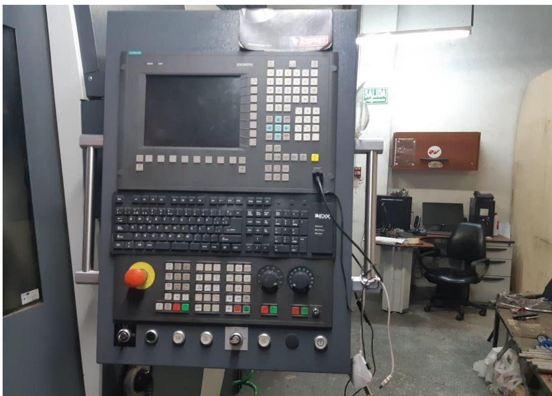
**Figura VI-4** Panel comunicación con la máquina torno.
