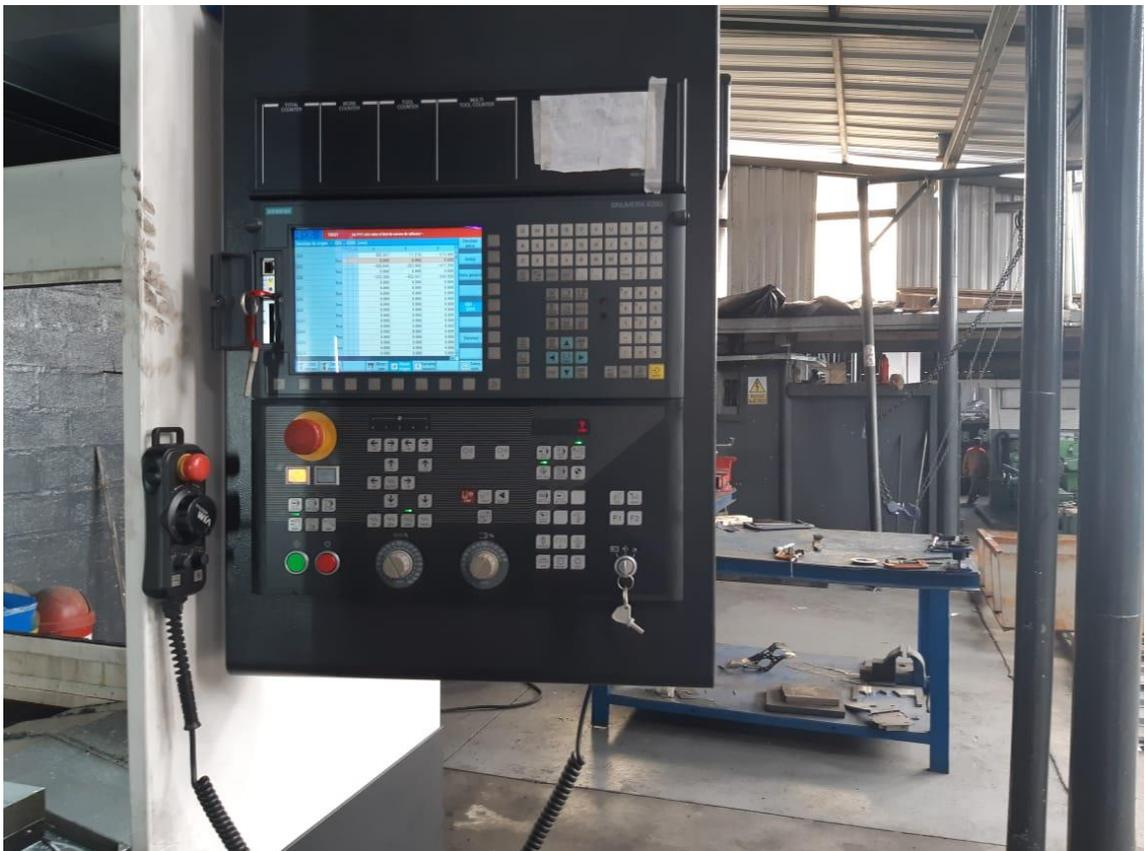
**Figura VI-6** Panel de comunicación con la máquina fresadora.
