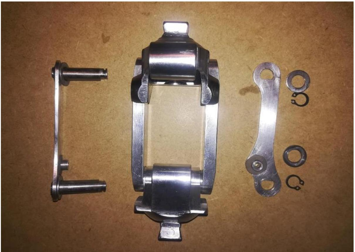
**Figura VII-6** Parte móvil lista para el montaje del amortiguador.
