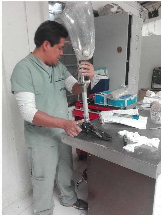
**Figura VIII-6** Colocación de rodilla en molde de plástico.
