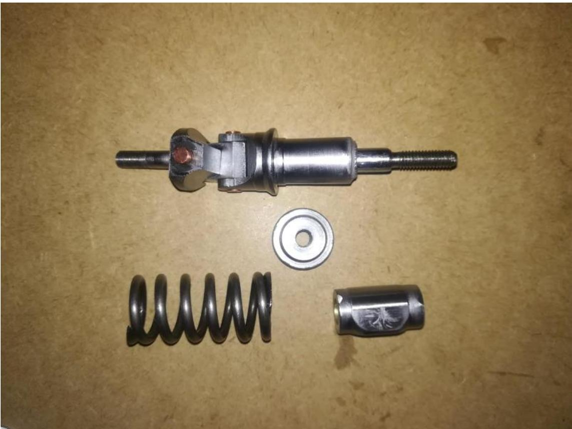
**Figura VII-14** Bases superiores de resorte y al sistema de movilidad.
