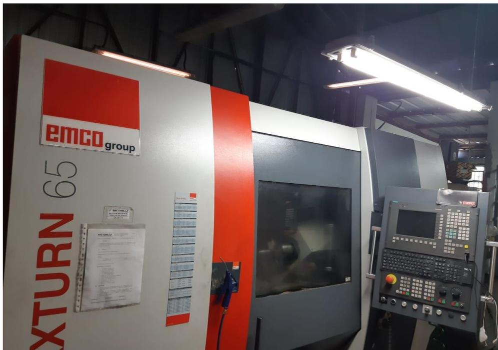
**Figura 3-35** Torno cnc de 5 ejes
