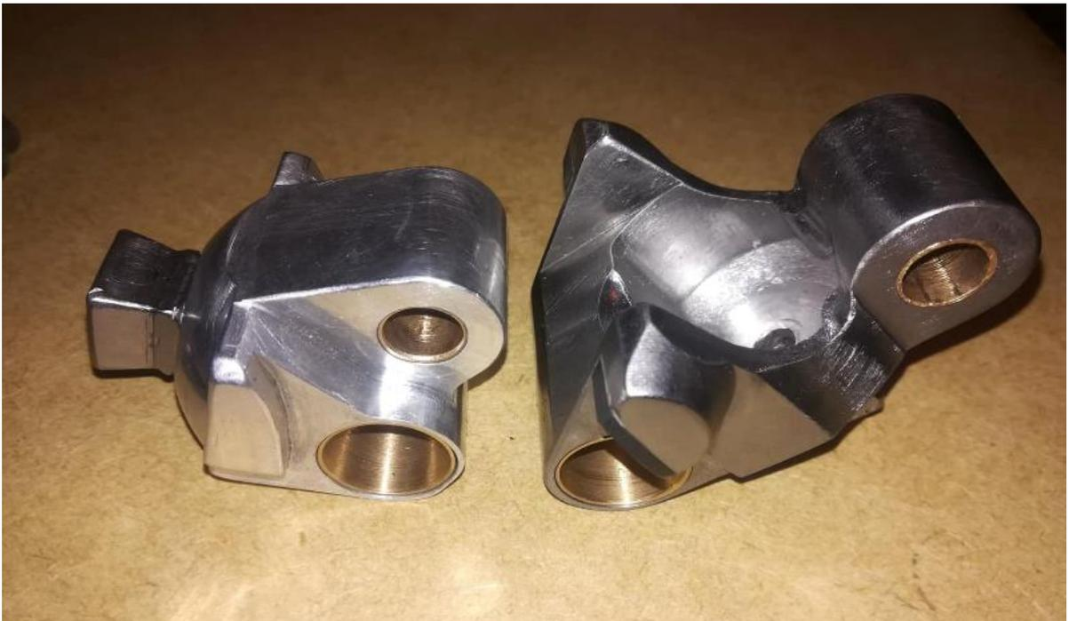
Figura VI-1 Colocación bocines en bases.
