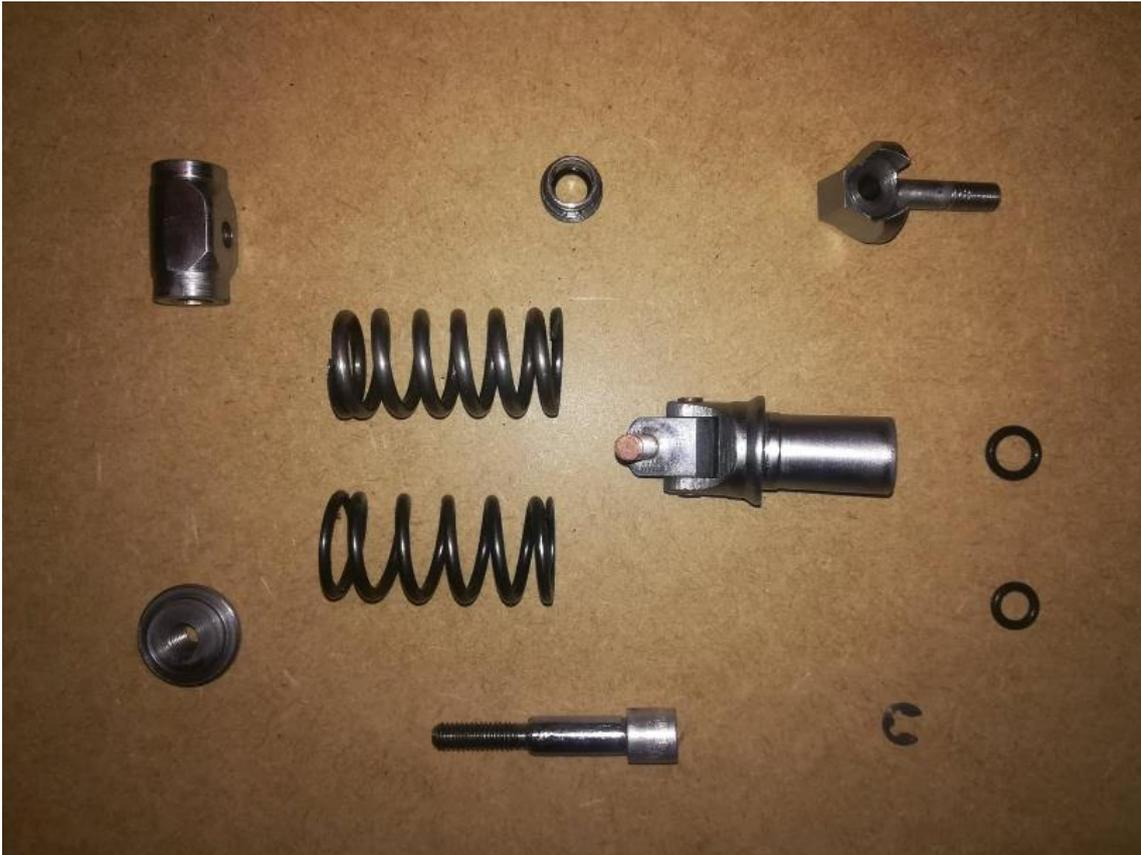
**Figura VII-7** Piezas Amortiguador.
