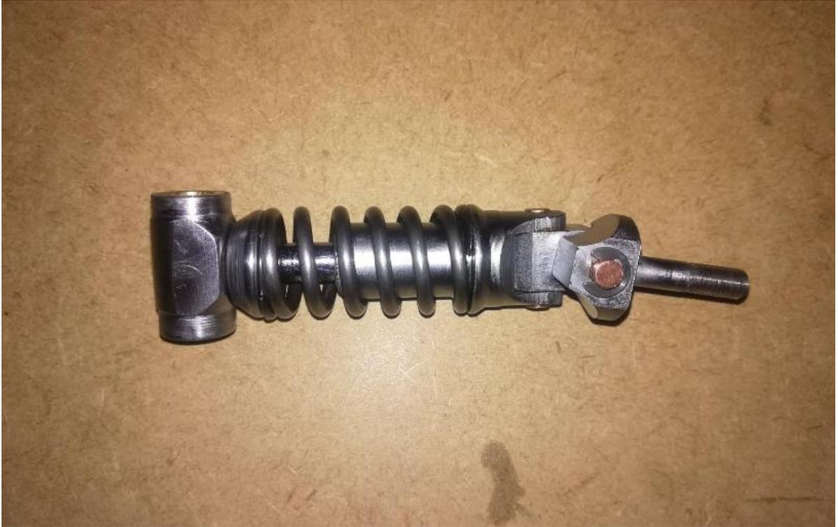
**Figura VII-15** Amortiguador.
