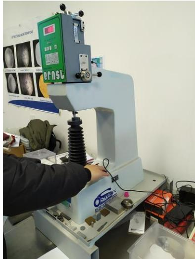
**Figura 5.19.** Ensayo de dureza – Durómetro
