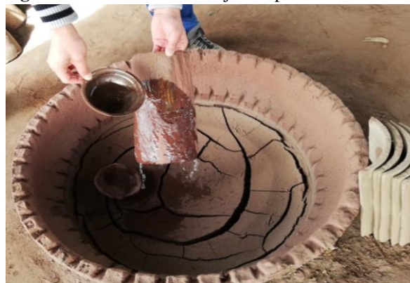
Figura N° 10 Barniz de la teja con plomo.
