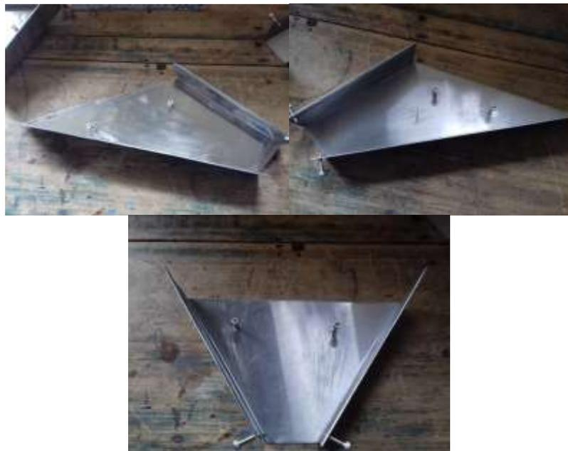
**Fig. 4.12.** Guías de salida del producto
