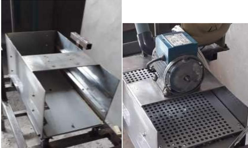
**Fig. 4.7.** Mesa vibradora
