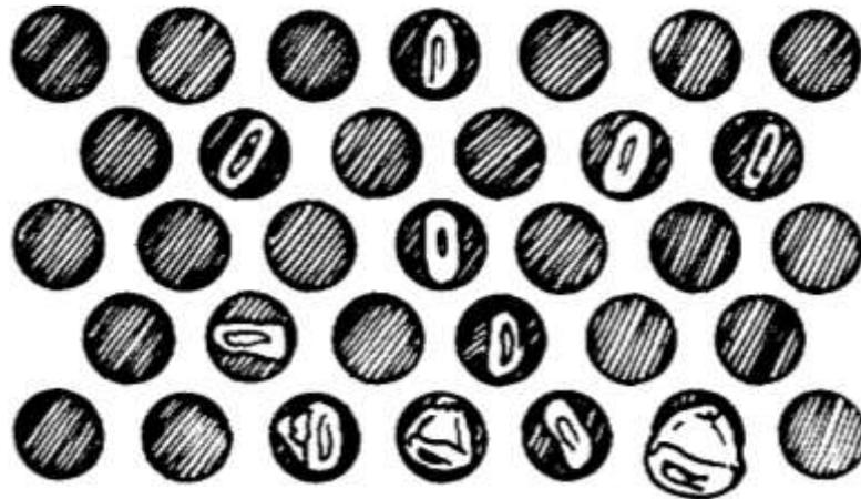
Fig. 3.2. Separación en función del ancho
