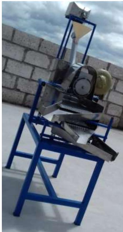
**Fig. 5.8.** Prototipo de máquina separadora y clasificadora de chochos
