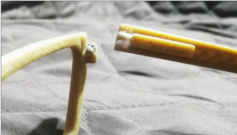
Figura 48: Bisagra de prototipo fallido
