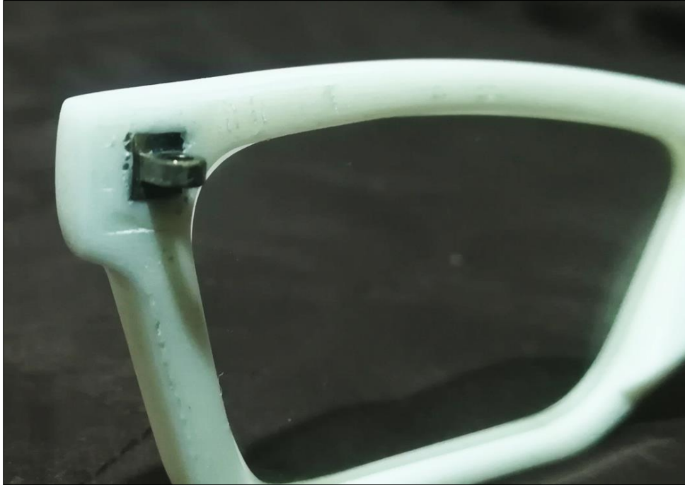
Figura 49: Bisagras parte frontal prototipo N°2
