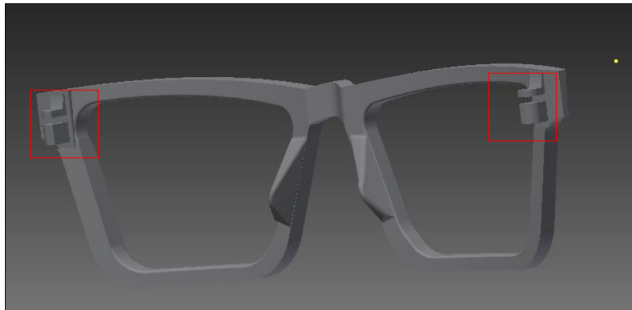
Figura 40: Bisagras en la parte frontal boceto N°1
