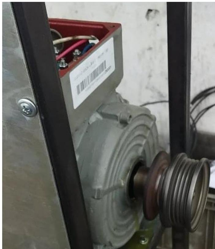
**Anexo G.4.** Conexión y montaje de poleas sobre motor
