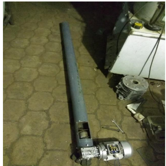
Ensamblaje del motoreductor con el tornillo sin fin
