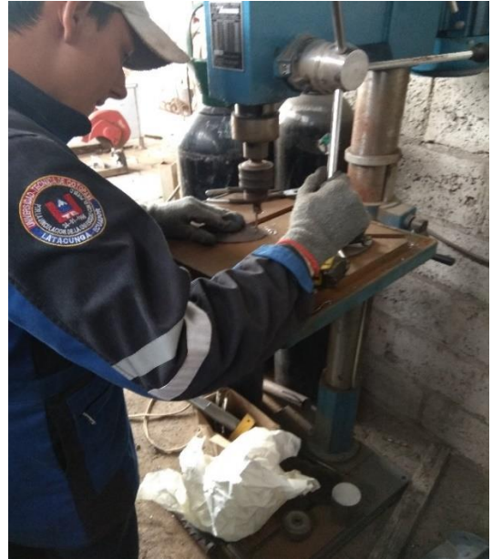
Perforación de la placa posterior del cañón
