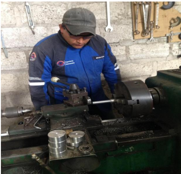
Torneado del eje del tornillo sin fin
