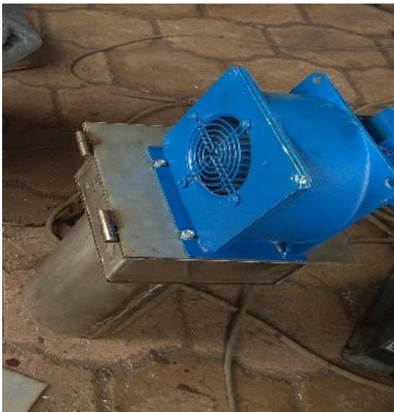
Ensamble del ventilador de aire forzado con la recámara
