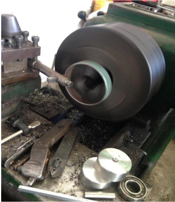
Torneado de la brida del motoreductor
