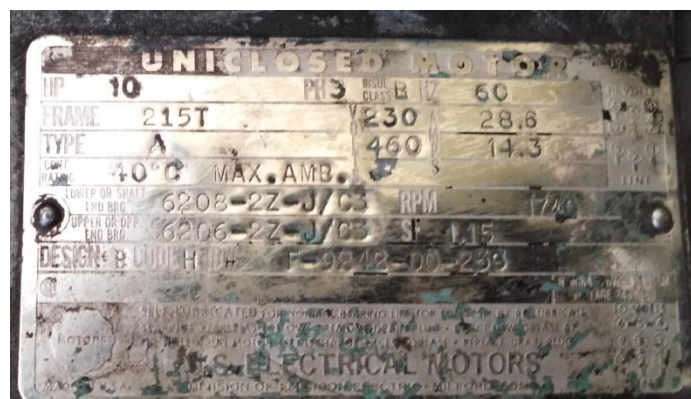
Figura 5.24 Placa de datos del motor extrusor
