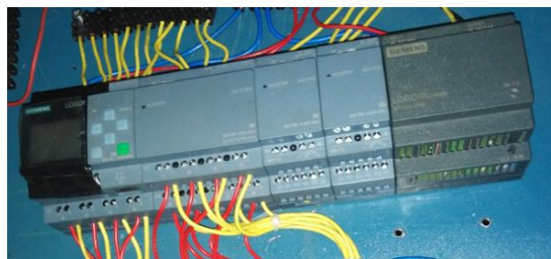
Figura 5.18 Control de temperatura con Logo v8 y Módulo AM2 RTD de la máquina extrusora
