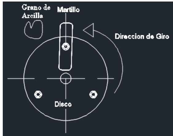
Fig 4.6. Impacto fragmento de arcilla- martillo.
