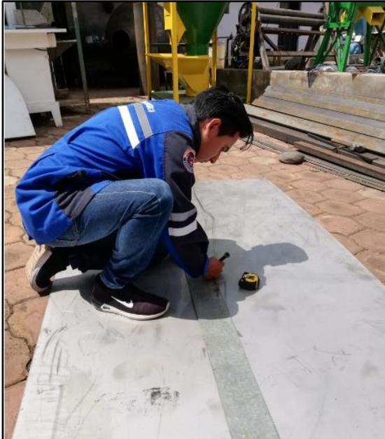
**Trazo de las paredes del cilindro**
