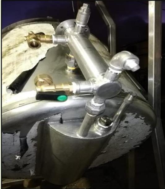
Ensamblaje del caldero y visor de agua
