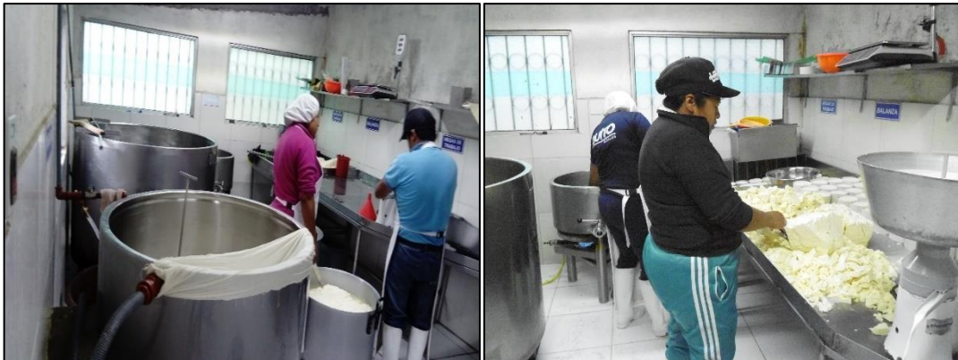
Fotografías 9 y 10: Retiro de la masa cuajada en reposo y corte
