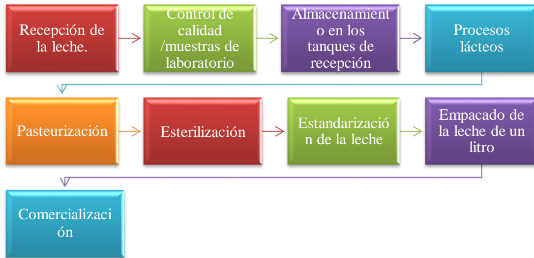
Figura 12: Proceso del empaqueo de leche de un litro
