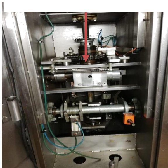
Ilustración 2: Mantenimiento de sus engranajes de la máquina empackador de leche.
