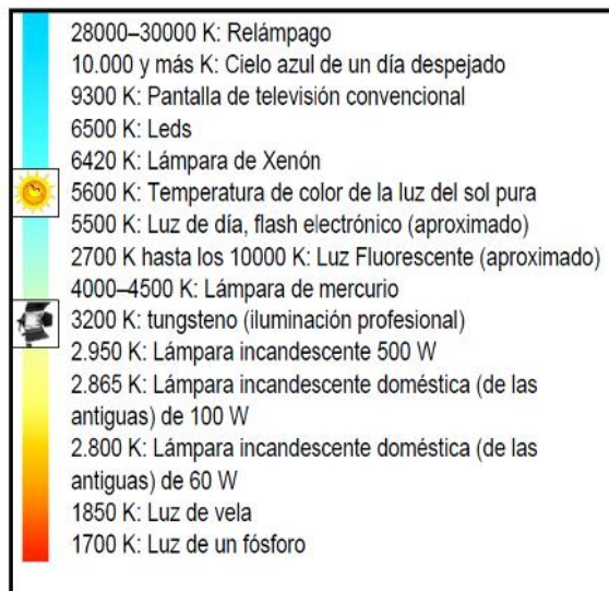
Figura 3.13 Se clasifican, en grados Kelvin (K), diferentes fuentes de luz según su dominante de color.
