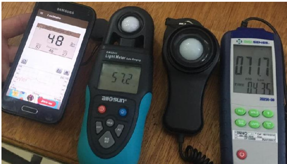
Anexo 16.1 Comparación con otro equipo de medición (propiedad del laboratorio de la facultad) y programa de telefonía (luxómetro: smart luxmeter) disponible gratis en la Google Play para sistema Android.
