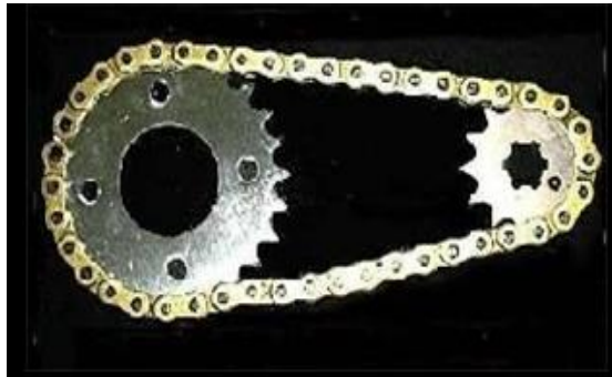
Figura 3.20. Transmisión por cadena Fuente: [23]
