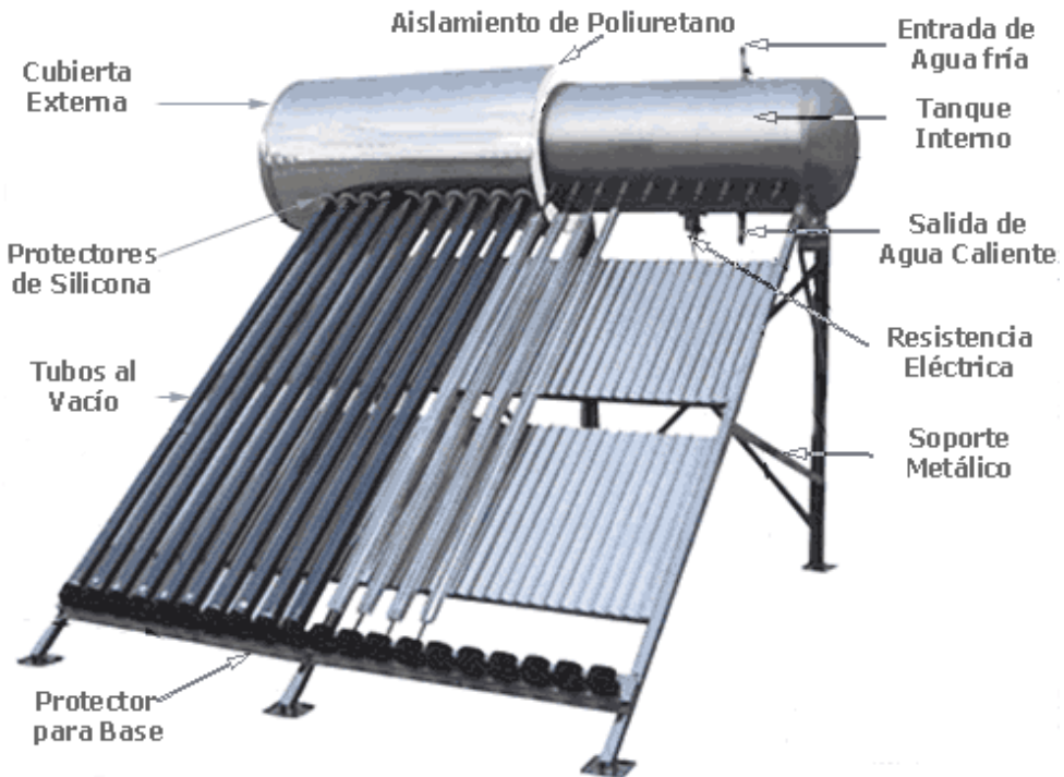
Figura 3.10.- Estructura del SST
