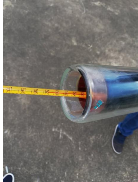
Anexo VII.4.- Medición de la temperatura interior del tubo de vacío
