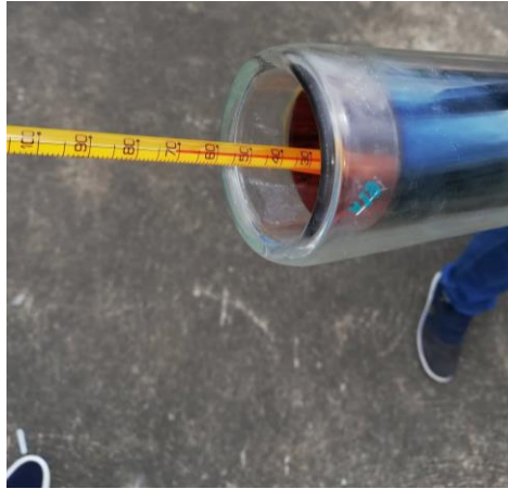
Fig. 5.- Verificación de la temperatura interior del tubo
