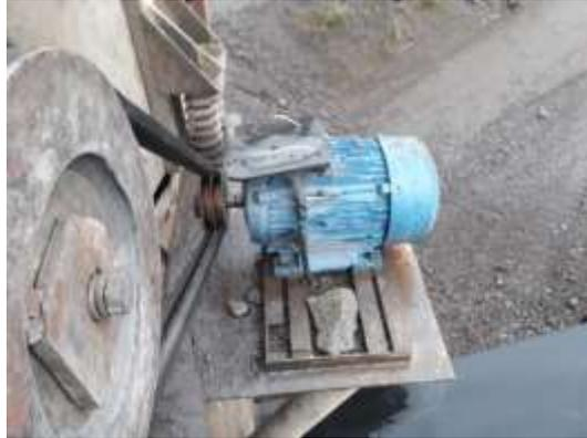
**Figura 4.3.** Motor instalado en la etapa de clasificación de arena, ripio y materiales medios.
