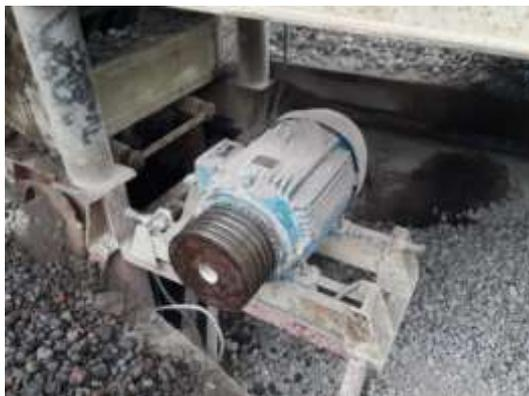
**Figura 4.5.** Motor utilizado en la trituración de 40 HP
