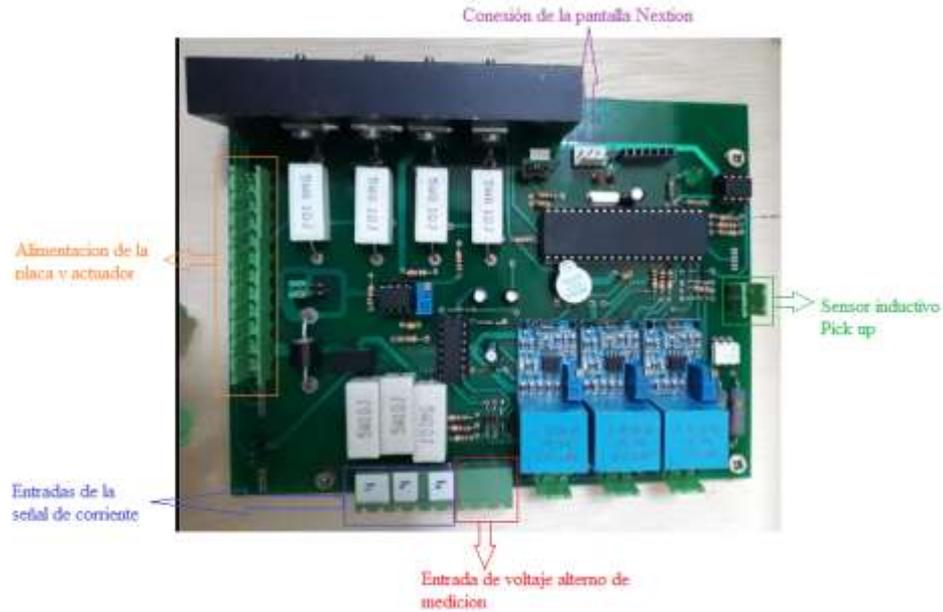
**Figura 4.23.** Placa construida.
