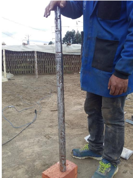
Figura 11. Eje del tornillo extrusor
