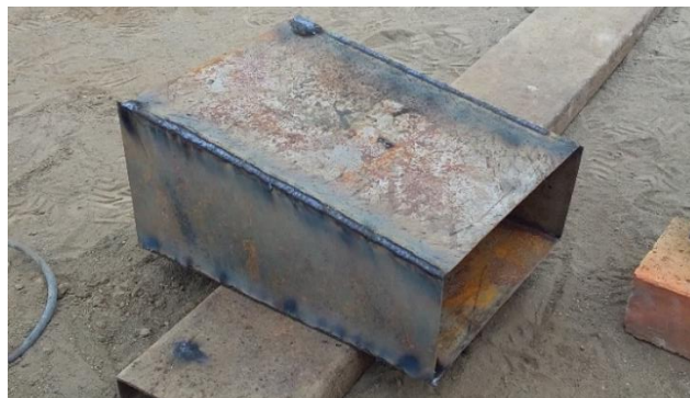
Figura 21. Proceso de soldadura de elementos de la boquilla
