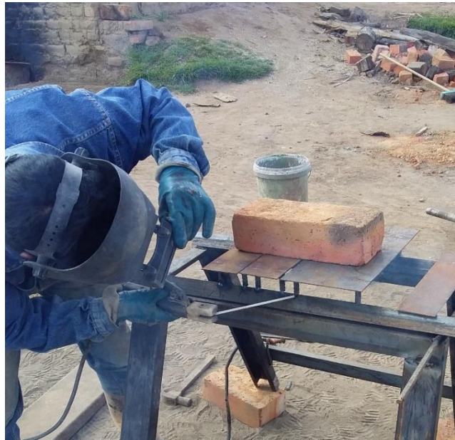
Figura 28. Proceso de soldadura de la cortadora
