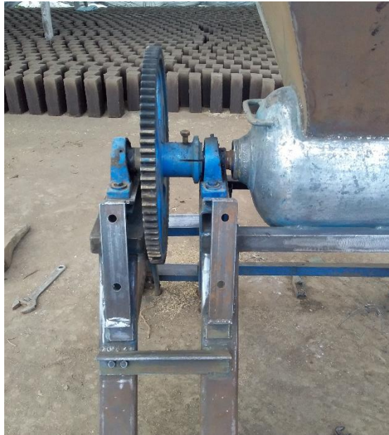
Figura 23. Montaje del engranaje (90 dientes)
