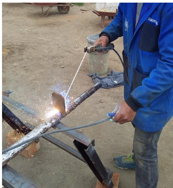
Figura 12. Proceso de soldadura a elementos del tornillo
