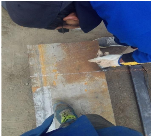
Figura 20. Corte de plancha anti abrasiva
