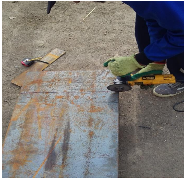
Figura 25. Corte de plancha anti abrasiva
