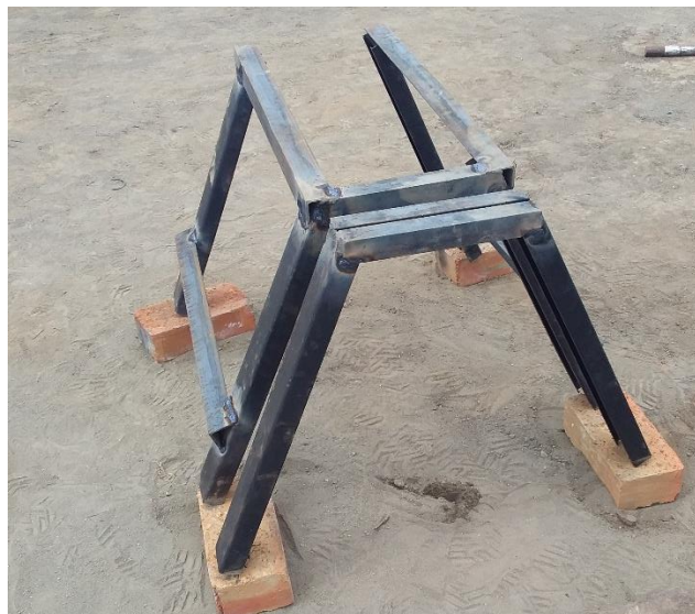
Figura 10. Estructura de la máquina extrusora
