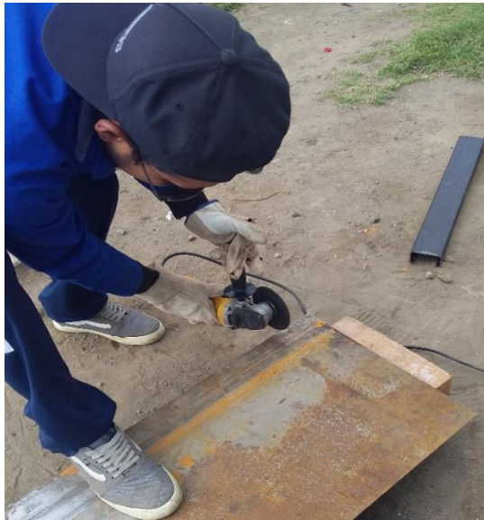
Figura 3. Proceso de corte plancha anti abrasiva
