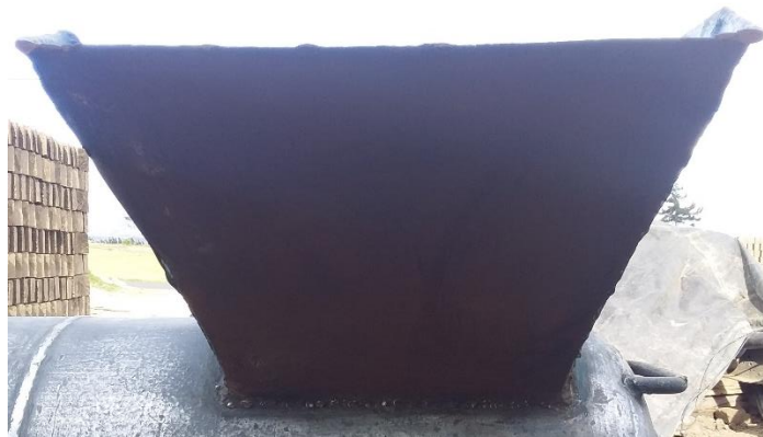
Figura 4. Montaje del sistema de abastecimiento (tolva)
