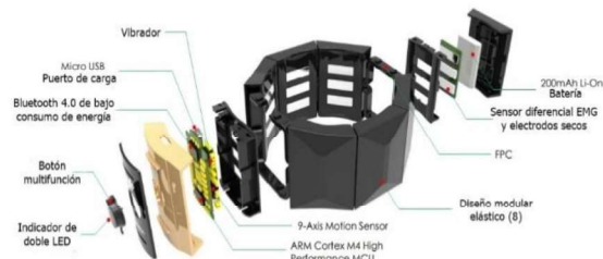
Figura 3. 26. Componentes del sensor gForce 100 ARMBAND
