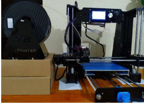
Figura III. 39. Ubicación del carrete de filamento PLA.
