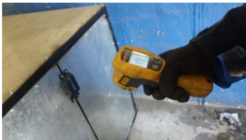
Figura 6. Verificación de la temperatura en la parte exterior del horno.
