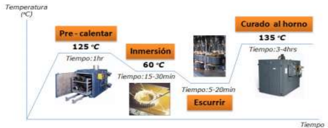
Figura 1. Proceso de barnizado recomendado para el barniz BC 346A de Dolphs.
