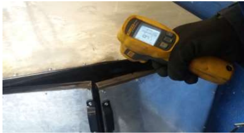
Figura 2. Revisión de la temperatura en los bobinados del motor.
