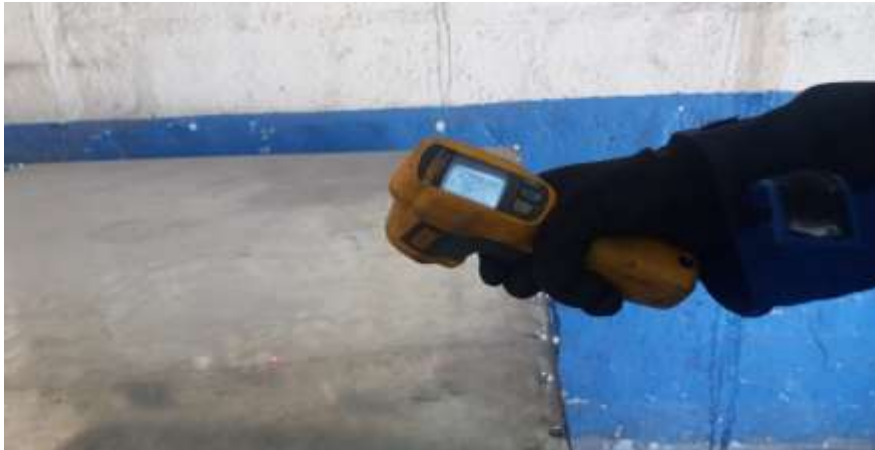
Figura 5. Verificación de la temperatura en la parte exterior del horno.
