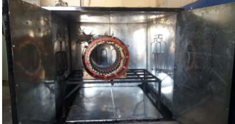
Figura 1. Ingreso del motor de 75 hp al horno.
