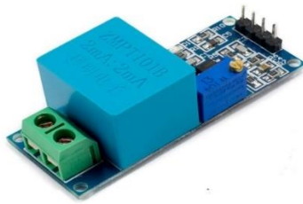
Figura 3.11. Sensor de transformador de voltaje
