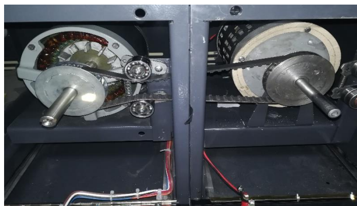
Figura 4 Colocación de la banda 84ZA19
