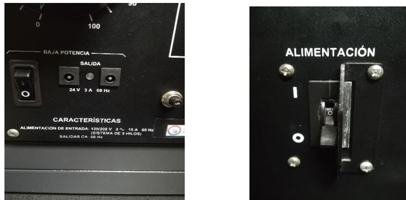
Figura 7 encendido de la fuente para que arranque el modulo del motor de jaula de ardilla 4 polos
