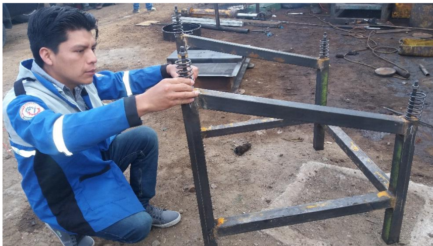
Figura XVI.2. (Colocación de muelles en la estructura del equipo tamizador)
