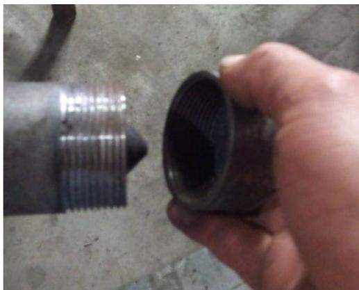
6.- Una vez retirada la boquilla se procede a extraer el tornillo extrusor para realizar su limpieza adecuada y dejar sin residuos del material tanto en el cilindro como en el tornillo
