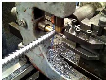
**Figura 5. 2** .Proceso de maquinado del tornillo extrusor
