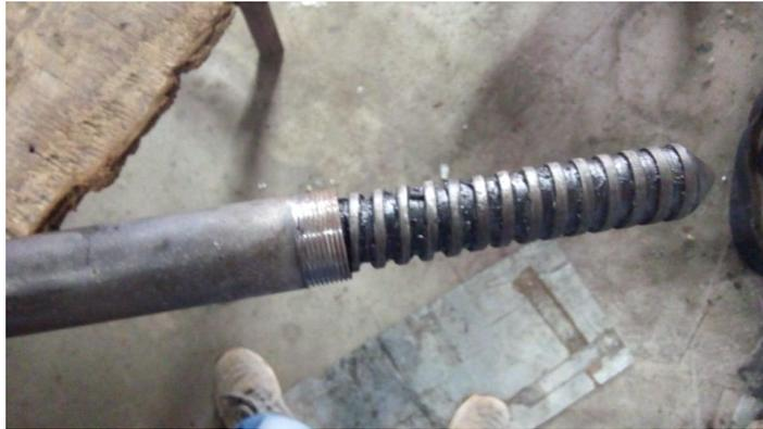
8.- La limpieza del tornillo se lo ara utilizando la herramienta o material adecuado para que el tornillo no sufra cualquier tipo de daño
