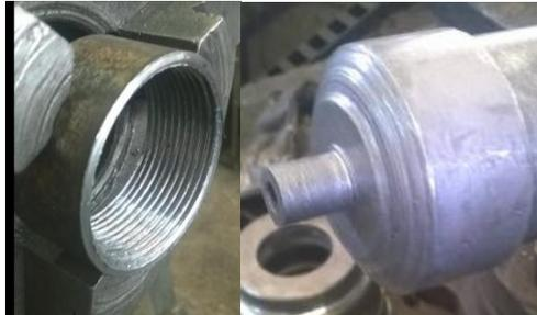
**Figura 5. 7** Maquinado de la boquilla de la máquina extrusora
