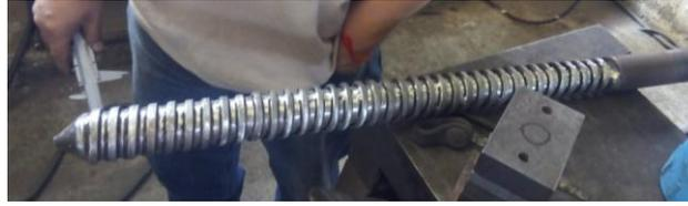
**Figura 5. 3.**Tornillo extrusor
