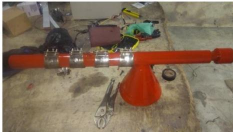
5.- Una vez desmontado en cuerpo de los soportes se procede a retirar la boquilla del cilindro
