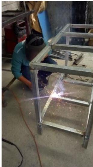
**Figura 5. 9.** Armado de la estructura de soporte de la máquina extrusora
