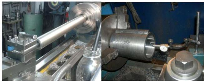
**Figura 5. 4.** Proceso de fabricación del cilindro por arranque de viruta
