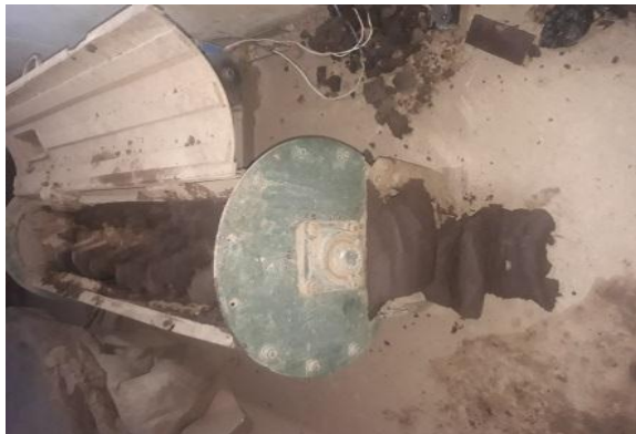
Figura 16: Molida de la arcilla
