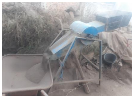
Figura 15: Triturado de la arcilla
