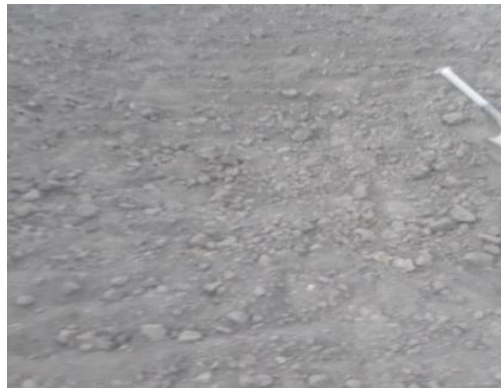
Figura 14: Secado de la arcilla.
