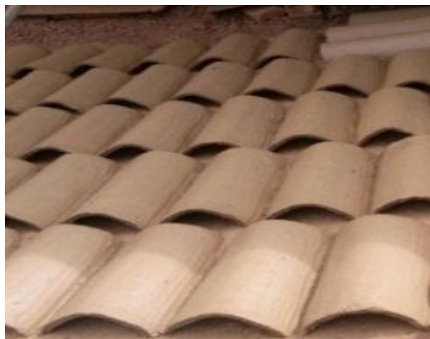
Figura 5: Secado de la teja
