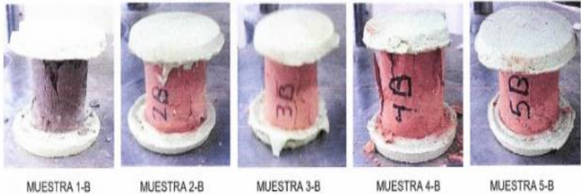
Figura 21: Pruebas a compresión bajo normas (ASTMC42)
