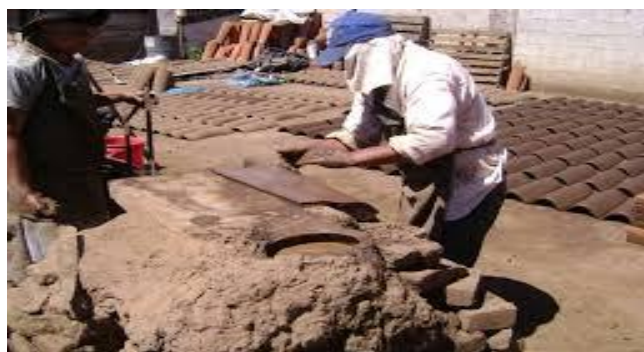
Figura 4: Moldeo de la arcilla
